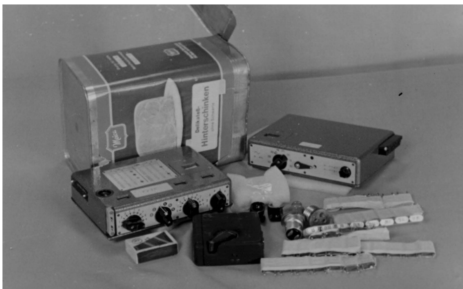
Teil einer CIA-Funkanlage, versteckt in einer Konservendose, ohne Datum.
